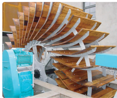
発電機(水色の機械)と下掛け水車
